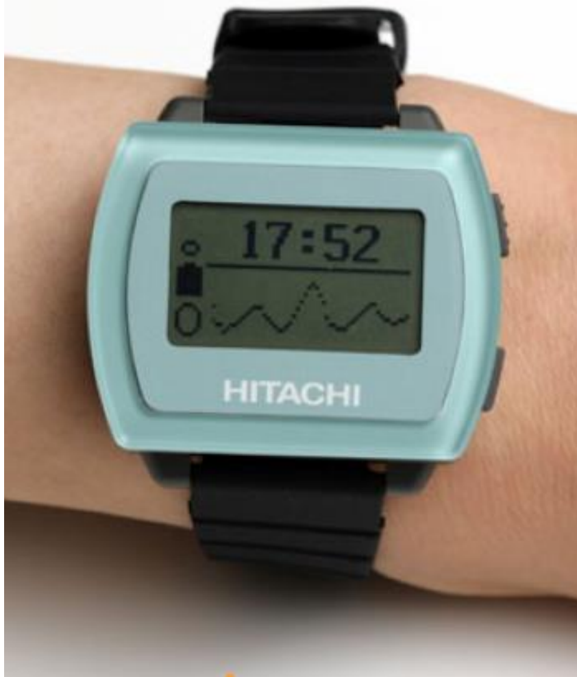
無線通信技術を利用した脈波モニタリング装置 (日立製作所との共同研究)2008年 知的クラスター創成事業第II期 試作品
