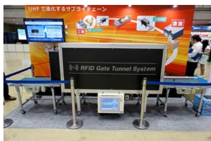
流れる商品に貼付されたRFIDを認識し商品特定するのデモの様子
