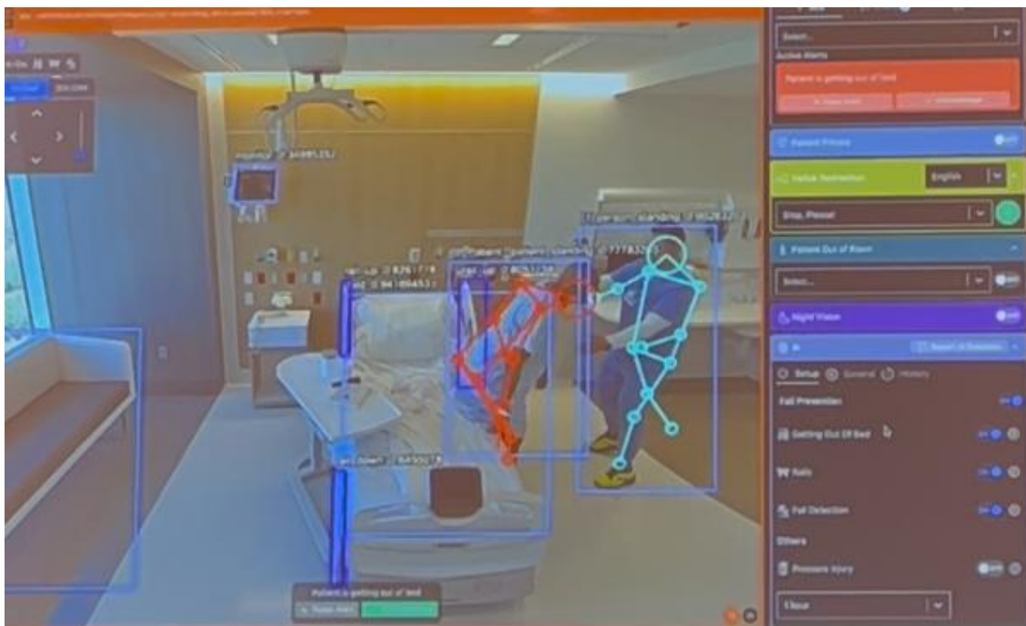
図 3.3.2-3 転倒防止アンビエントモニタリングの動作デモ映像（骨格モデル表示）
