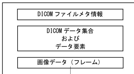
図 6-1 シングルフレーム構造
