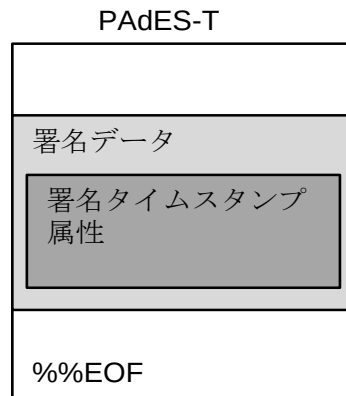
図 6.5.2 PAdES-T プロファイルの PDF データ構造のイメージ
