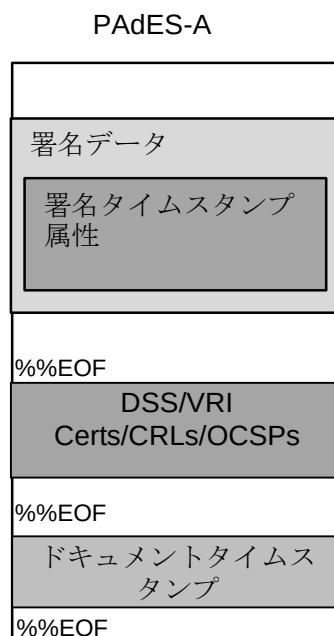
図 6.5.3 PAdES-A プロファイルの PDF データ構造のイメージ
